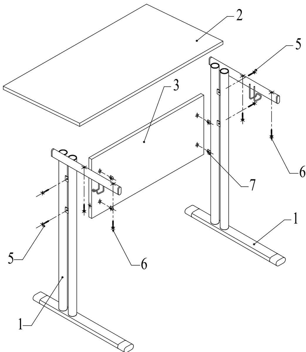
6.1. При помощи винтов (5) и гаек (7) соединить боковины (1) экраном (3).
