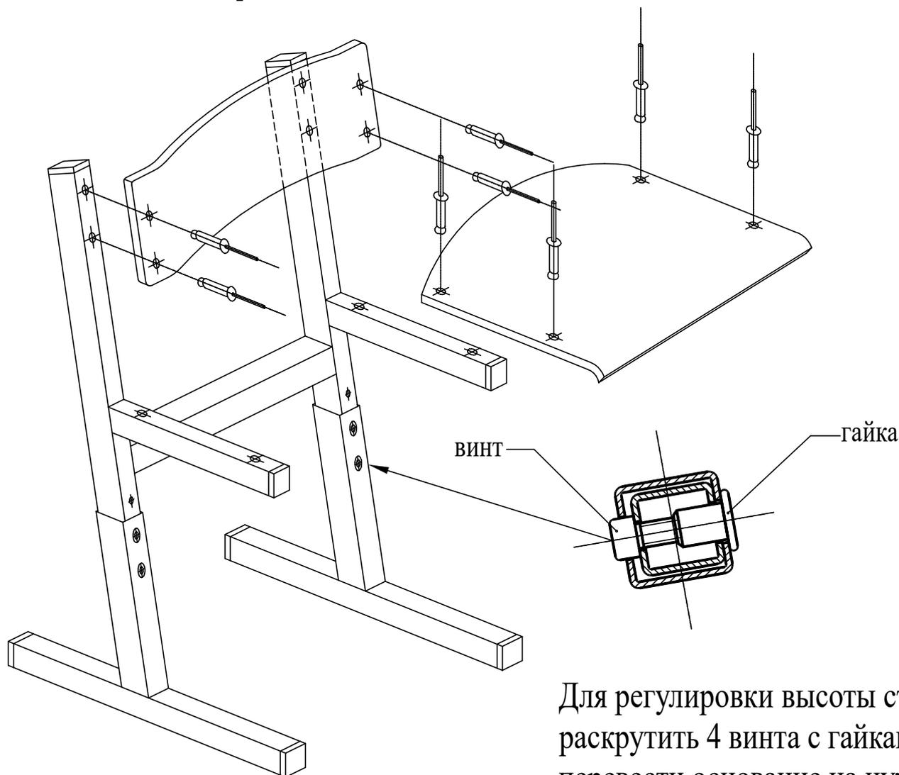
Для регулировки высоты стула раскрутить 4 винта с гайками, перевести основание на нужную высоту и закрутить винты вновь.
